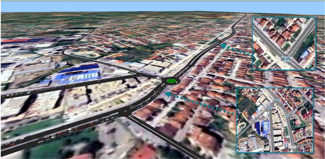
Fig.35. Analiza infrastrukturore dhe operimi trafikut - kryqëzimi me prioritet ndërmjet rrugëve të qasja në autoudhë (Prizren - Veri)
