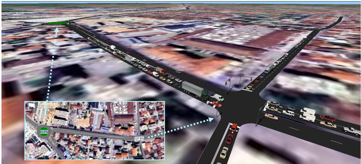
Fig.37. Analiza e kapacitetit ideal të kryqëzimeve në rrethrotullimet në afërsi të qendrës tregtare
